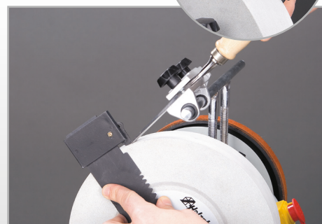
· Étape 3 : Réglage de la position sur le support universel déterminant l'angle d'affûtage
