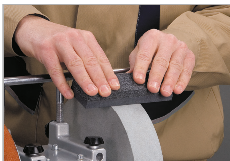
· Préparation de la meule 2 grains (gros/fin) (code article 591 0030)
