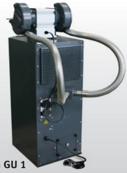
Fig. : Socle avec groupe d'aspiration GU 1
