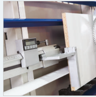
· Indicateur dimensionnel numérique pour le réglage de la longueur lors d'une coupe verticale
