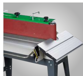
· Table transversable orientable jusqu'à 45° pour le ponçage des chants
