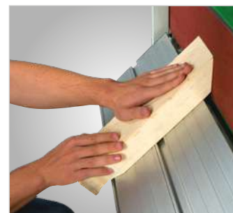
· Réalisation d'onglets jusqu'à 45° par inclinaison de la table longitudinale
