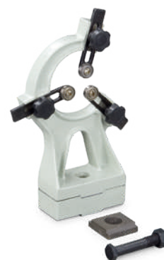
Fig. : Lunette fixe DB 900/1100 · Indispensable lors du travail des pièces dont la longueur est trop importante ou le diamètre trop faible pour les usiner en "montage en l'air" · Permet d'empêcher les vibrations et les marques de broutages sur la pièces à usiner en rotation. · Voir détails page 86
