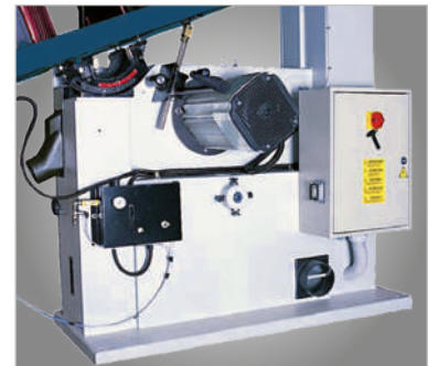
· Inclinaison de la table par crémaillère et commutateur étoile/triangle automatique
