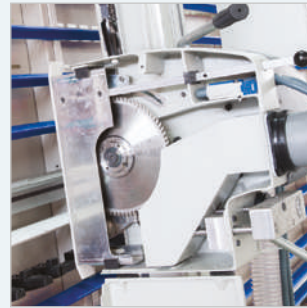
· Grande ouverture pour un changement de lame de scie simple et rapide
