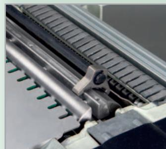
· Les fers du rabot sont parfaitement ajustés à l'aide du calibre de réglage.
