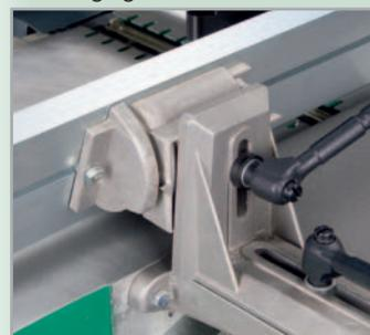
· Le guide latéral en aluminium est inclinable sur 45°. L'inclinaison est parfaitement lisible sur une échelle graduée précise.
