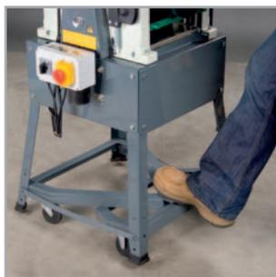
La machine est dotée en série d'un système particulièrement pratique pour faciliter son déplacement dans l'atelier. Pour bouger la machine il suffit simplement d'enfoncer le pied sur la barre horizontale du mécanisme de déplacement afin de positionner les roues en position basse. En relâchant la bride à ressort, la machine reprend sa position de départ.
