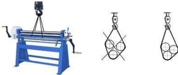
Fig. 4: Transport avec une grue
