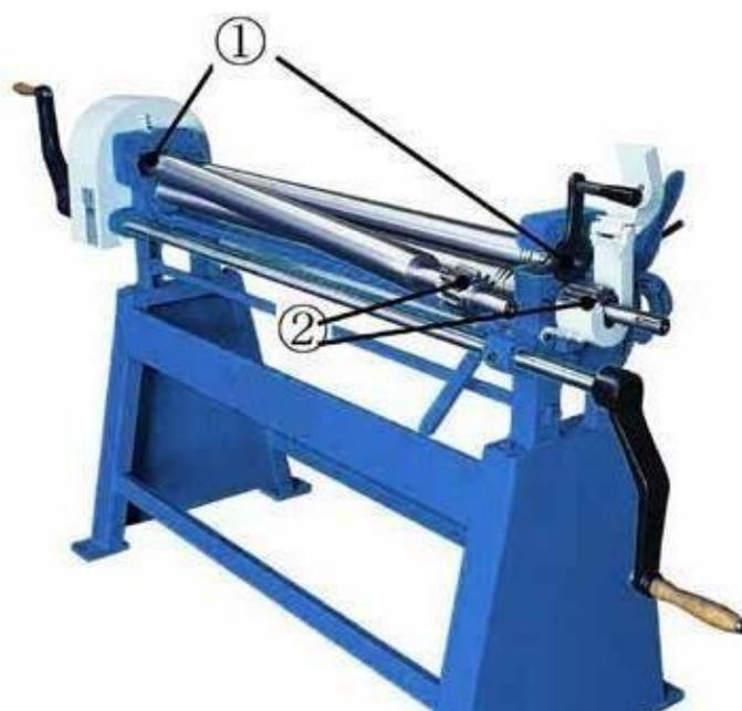
Fig. 19: Endroits à graisser sur la rouleuse
