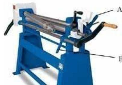
Fig. 10: Manettes pour le mouvement des rouleaux
