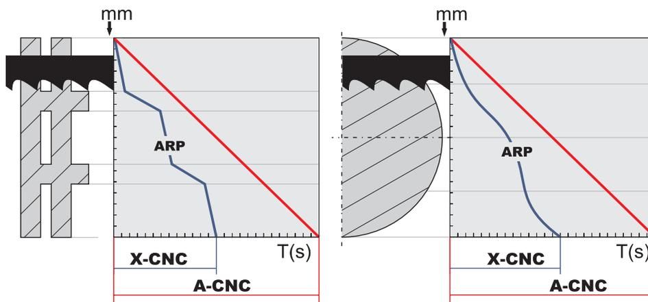
Le système ARP garantit une régulation automatique des mouvements de l'archet en fonction de la valeur actuelle de la résistance à la coupe du matériau, laquelle est basée sur les forces de coupe produites. Le système ARP réduit automatiquement la vitesse de descente à mesure que la résistance augmente, garantissant ainsi des résultats de découpe optimaux avec un haut degré de précision angulaire.
