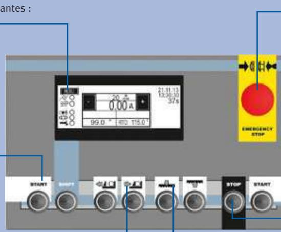
► Arrêt d'urgence - arrête la machine pendant un cycle
