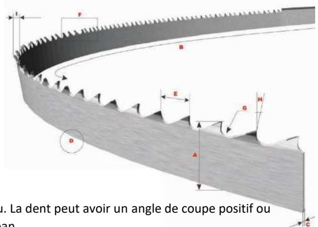
I - Avoyage : Inclinaison latérale des dents, à droite ou à gauche, pour permettre l'évacuation des copeaux pendant la coupe.
