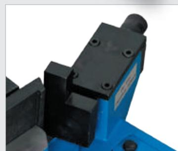
· Plaque de cintrage avec entrainement par vis sans fin permettant un positionnement facile et rapide
