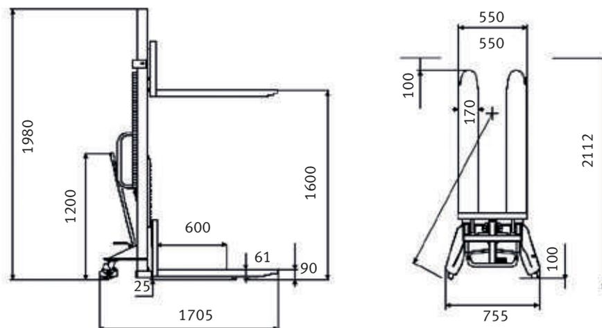
Fig.: schéma GHHW 1000
