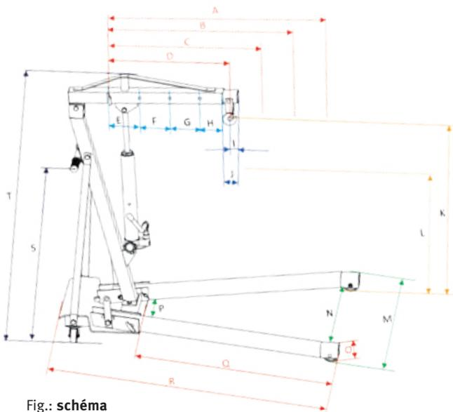
Fig.: schéma dimensions série WK
