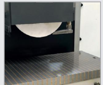
**Plateau de serrage électromagnétique**
