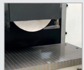
**Plateau de serrage électromagnétique**
