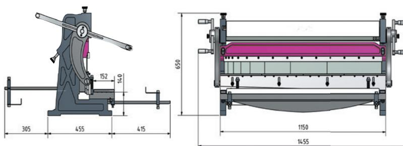
\* Cette valeur max. ne s'applique pas sur toute la largeur et dépend de la dureté du matériau usiné. Attention, les valeurs d'épaisseur sont données à titre indicatif sur des aciers 400 N/mm<sup>2</sup>. En fonction des matières et des utilisations, il convient d'appliquer un coefficient minoré ou majoré.
