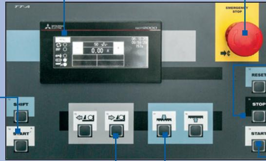
• Arrêt d'urgence - arrête la machine pendant un cycle
