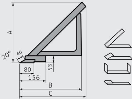
Fig. : Dimensions tabliers MSBM
