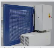
Protections de la zone arrière conformes à la norme CE avec panneaux latéraux et barrière immatérielle
