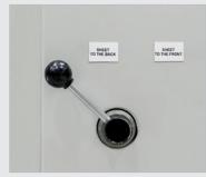
Levier de sélection pour le déchargement des tôles à l'avant ou à l'arrière
