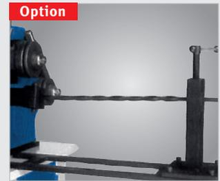
② Dispositif à réaliser les torsades (en option)
