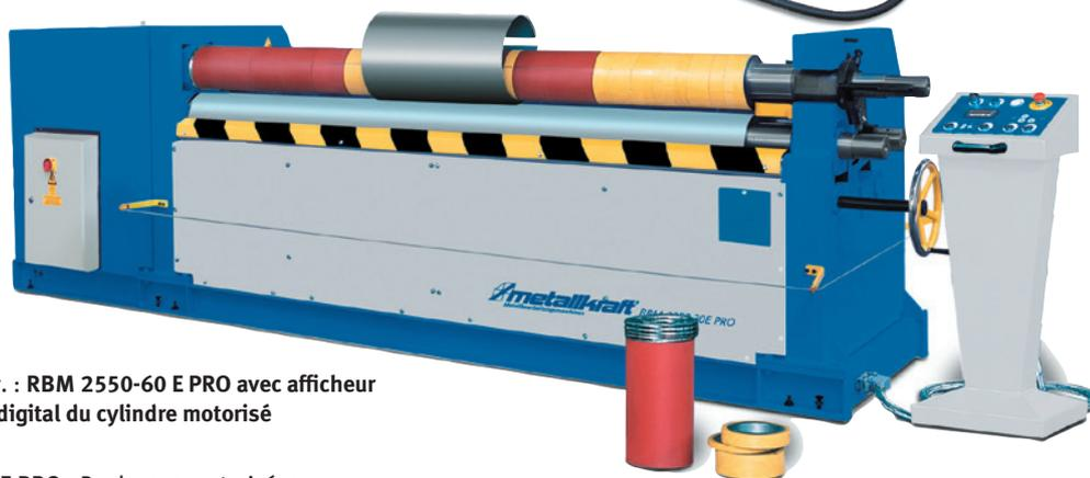
Fig. : RBM 2550-60 E PRO avec afficheur digital du cylindre motorisé
