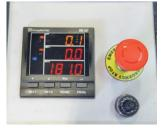
Utilisation simple. Commande numérique pour le réglage des angles de cintrage
