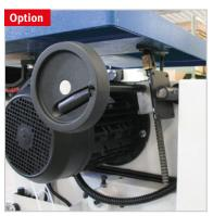
Option dispositif d'inclinaison de la table avec réglage à crémaillère.
