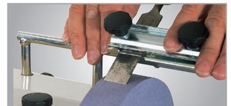
• Dispositif universel pour fers de rabot et ciseaux à bois (code article 576 0062)
