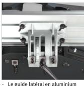
Le guide latéral en aluminium est inclinable sur 45°. L'inclinaison est parfaitement lisible sur une échelle graduée précise (Fig. : ADH 250)
