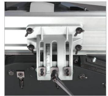
• Le guide latéral en aluminium est inclinable sur 45°. L'inclinaison est parfaitement lisible sur une échelle graduée précise (Fig. : ADH 250)
