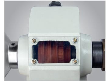
• 5 plages de vitesses avec changement de courroie simple et rapide par levier de serrage. Avec regard afin de contrôler la vitesse sélectionnée
