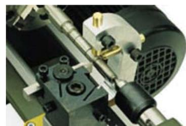
**Dispositif de tournage radial**
