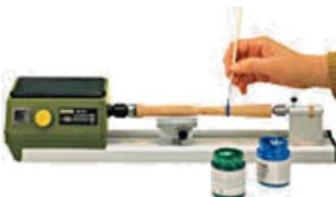
Le réglage électronique du régime permet même à bas régime une «mise en peinture semi-automatique».
