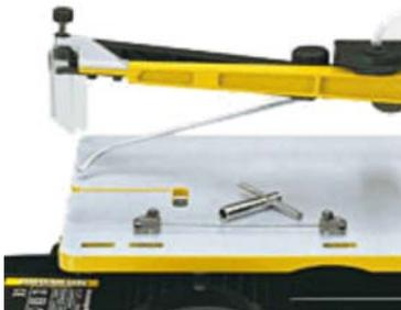
**Les pierres de coulisse (breveté) permettent avec un effort élevé,** d'assurer un alignement précis des lames. Les cavités dans la surface de la table servent de ligne de guide pour définir la position et l'assemblage de la lame de scie.
