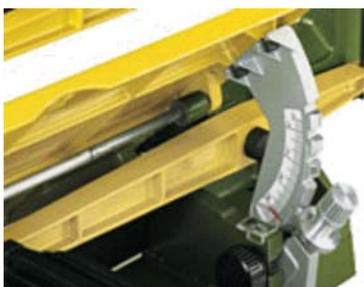
**La table peut être réglée de -5° à 50°** pour des coupes en biais. Avec un quadrillage de grandes dimensions de 0°, 10°, 20°, 30° et 45°, et un positionnement de précision ajustable.
