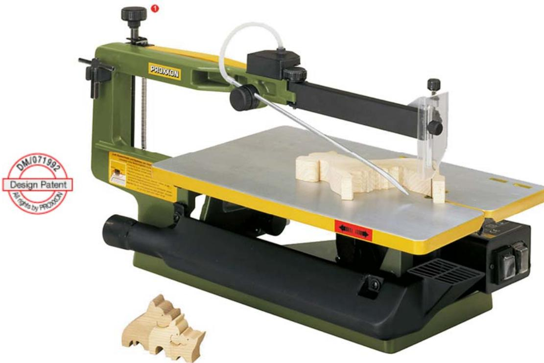
**1** Extrêmement important: Un bouton rotatif permet une fixation sensible des lames de scie.
