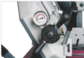
**Machines équipées d'un manomètre**
