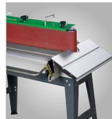
• Table transversale orientable jusqu'à 45° pour le ponçage des chants
