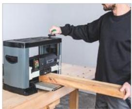
· Réglage en hauteur par manivelle et graduation
