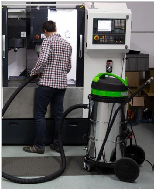
Fig. : Exemple d'application. Aspiration de copeaux métalliques après usinage sur fraiseuse Optimum F 150
